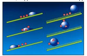
Wachskristallen und sind für den Selbstreinigungseffekt verantwortlich. Das Prinzip: Kommt ein Schmutz- oder Wassertropfen nur mit den Noppenspitzen des Blattes in Kontakt, ist die Auflagefläche des Tropfens auf der Blattfläche sehr klein. Ebenfalls gering sind dadurch auch die Anziehungskräfte zwischen Schmutz und Blatt. So bleiben die Partikel an der Oberfläche des Wassertropfens hängen und rollen mit ihm ab. Besonders gut sind diese
